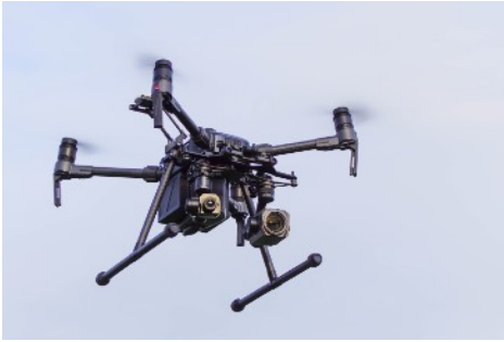
Unsere derzeit modernste Inspektionsdrohne mit Wärmebild und Normalbild-Zoomkamera gleichzeitig.
